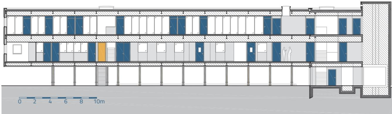
Le volume sur pilotis est entièrement réalisé en charpente métallique. La portée de ses planchers sur 12 mètres permet un aménagement flexible des plateaux sur plan libre et la création d'un parc de stationnement supplémentaire sous l'édifice.
